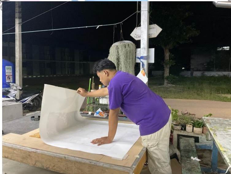
ภาพที่ 3.28 นำแม่พิมพ์วางบนบล็อกและวางกระดาษทับลงไปบนแม่พิมพ์ ที่มา : ชิตฉาน ปุลาสะโต, 2565
